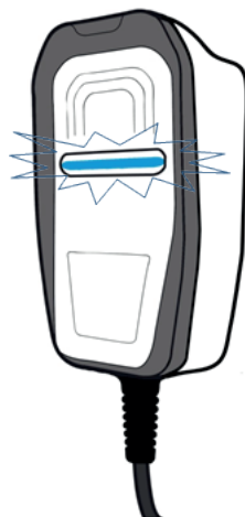
Figura 42: La estación de carga no dispone de suficiente corriente.
