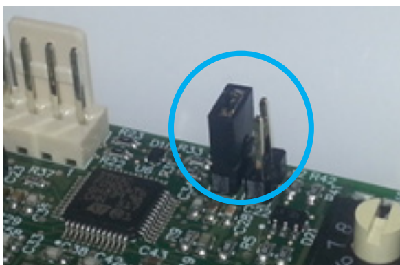
Figura 38:Jumper de la entrada de control remoto.
